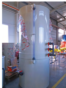
Nádrž se stavoznakem
